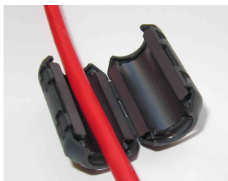
Gleichtaktunterdrückung durch Drossel
