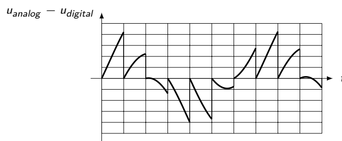
Fehler zwischen analogem und digitalisiertem Signal
