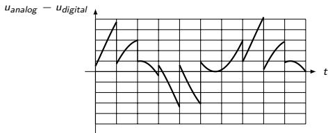
Fehler zwischen analogem und digitalisiertem Signal
